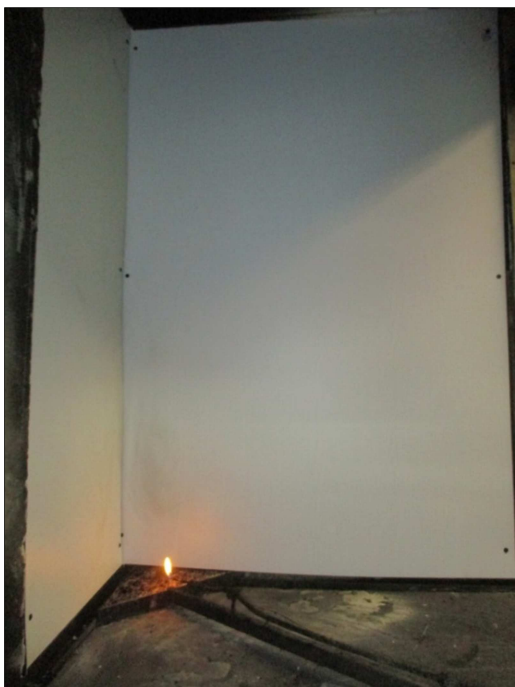
Vista totale della superficie esposta dell'ala lunga prima della prova Total view of the exposed surface of the long wing before the test
